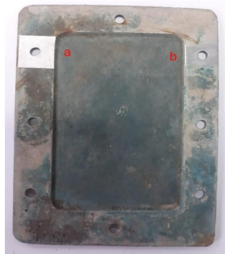
Figür 8. 3mm kalınlığındaki erişim kapağının lazerle yüzeyinin işlenmiş hali
